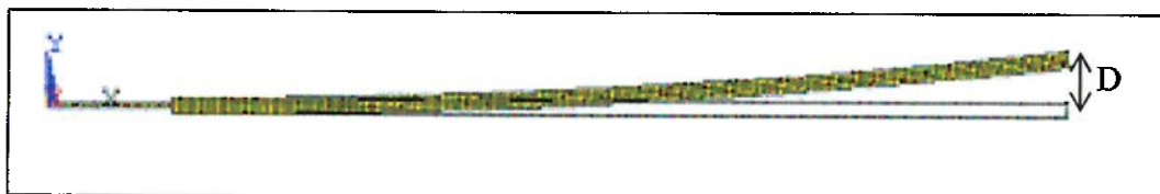
Fig. 6.14 – Resultados da simulação. Deslocamento obtido na extremidade direita do atuador D = 2,86 \times 10^{-6} \text{ m} .
