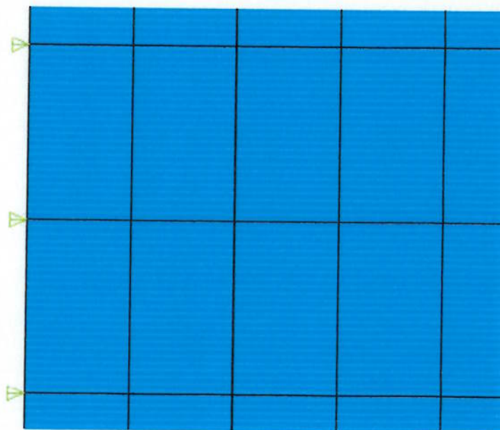
Fig. 4.9 – Detalhe da condição de contorno na entrada.
